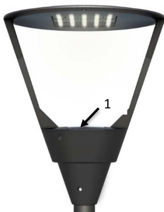
Um eine problemlose Wartung ohne Beschädigung des optischen LED-Systems zu gewährleisten, ist der Anschlussraum vom Leuchtengehäuse getrennt und durch Abnehmen des oberen Verschlusses des Anschlussraums (1) zugänglich. Durch Lösen der Verschlusschrauben lässt sich die Abdeckung abnehmen, die freien Zugriff auf die Verkabelungseinheit der Leuchte ermöglicht.
