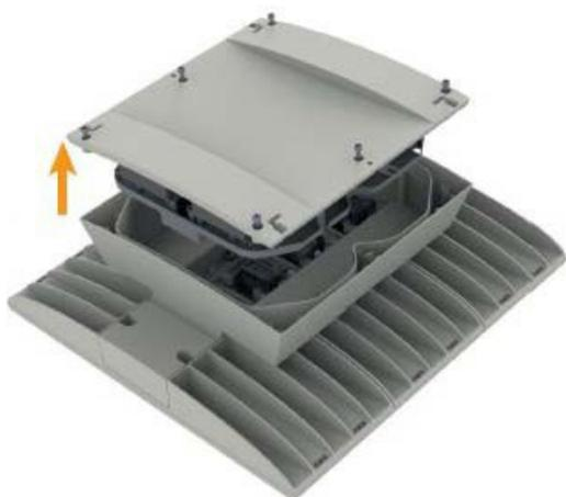
con el sistema óptico de led, el grupo de los componentes eléctricos está separado del grupo óptico, y se puede acceder a él aflojando los tornillos de cierre con sistema imperdible. La placa se extrae con facilidad desbloqueando las fijaciones de enganche a la estructura de la luminaria y desconectando los conectores eléctricos rápidos irreversibles por formas y color.
