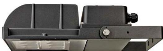
Vano ottico e vano alimentazione separati. Il vano componenti elettrici è accessibile dalla parte posteriore agendo sulle vite di blocco mediante l'utilizzo di utensili normalmente in dotazione. Durante queste operazioni il vano ottico rimane sempre protetto dallo schermo di chiusura in vetro piano.
